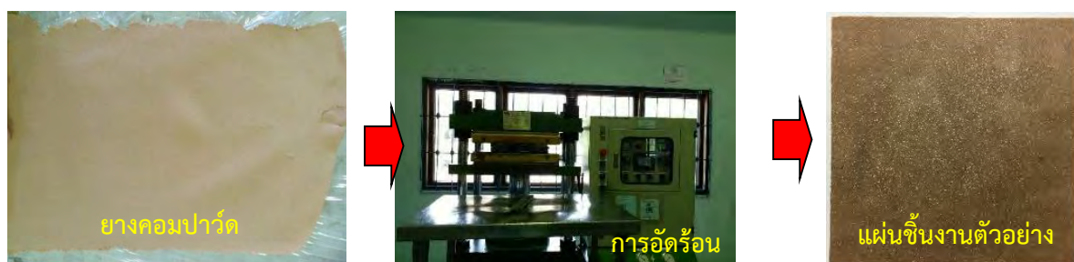
รูปที่ 1 การอัดขึ้นรูปวัสดุเชิงประกอบยางพาราและซีลี้อยไม้เป็นแผ่นขึ้นงานตัวอย่าง
