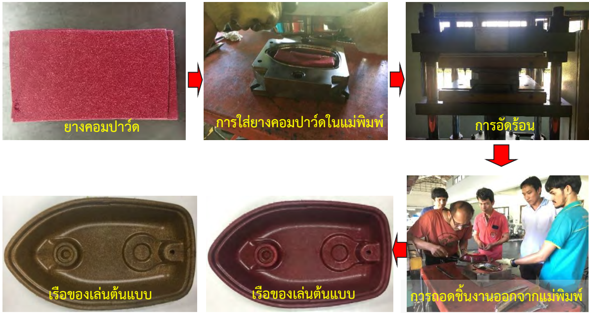
รูปที่ 4 การขึ้นรูปวัสดุแข็งประกอบยางพาราและซีลียไม้เป็นผลิตภัณฑ์เรือของเล่นต้นแบบ
