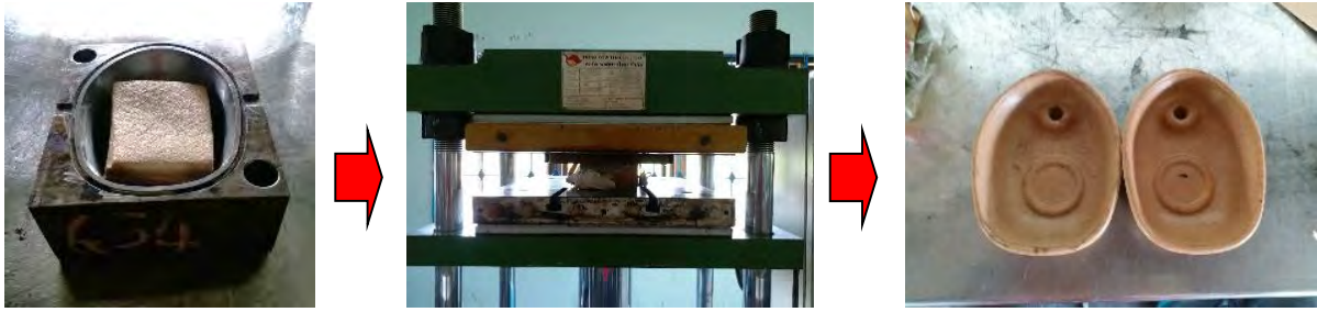
รูปที่ 2 การอัดขึ้นรูปวัสดุเชิงประกอบยางพาราและซีล้อยไม้เป็นของเล่นเด็กตัวอย่าง
