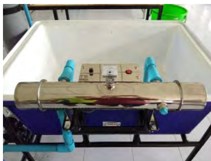
ภาพที่ 2 ระบบการฆ่าเชื้อในน้ำด้วยแสง Ultraviolet (UV)
